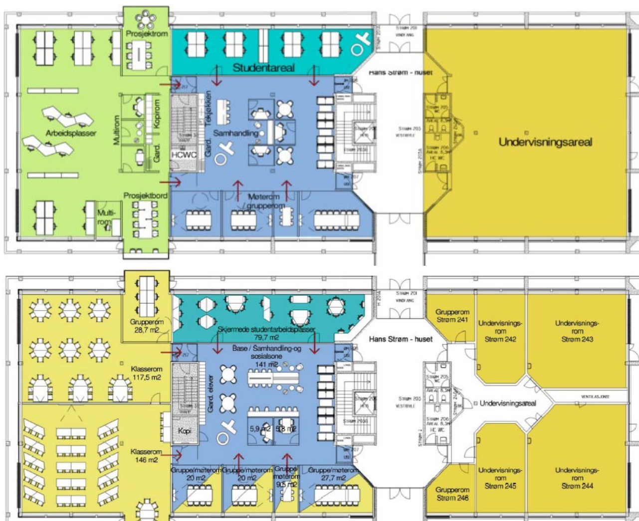
Figur 29 Illustrasjonar som viser mogleg innreiing og tilrettelegging av fråflytte areal i 2. etasje i Hans Strøm-huset. Eksemplet over viser ei kombinasjonsløyning med arbeidsplassar for tilsette, studentarbeidsplassar, grupperom/møterom og felles sosial sone. Eksempelet under viser eit liknande konsept, men med klasserom i staden for arbeidsplassar for tilsette. Illustrasjonar: Lerche Arkitekter
